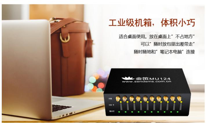
10个短信通道,可同时插入10张SIM卡,发送、接收速度是单通道的10倍。1小时在不限速情况下可发送6000条。
